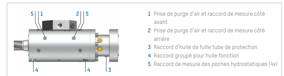
Illustration 7 : Prises de purge d'air et raccords de mesure du système de joints du vérin Servobear®
