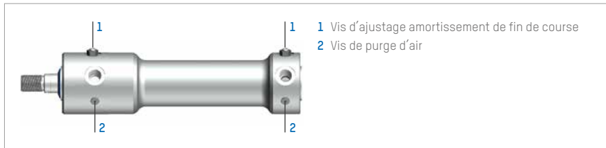
Illustration 9 : Régler l'amortissement de fin de course
