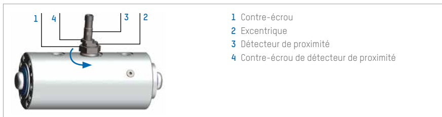
Illustration 17 : Régler le détecteur de proximité sur déverrouillé
