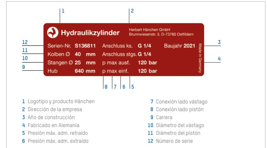
Figura 1: p. ej., Placa de características del cilindro hidráulico
