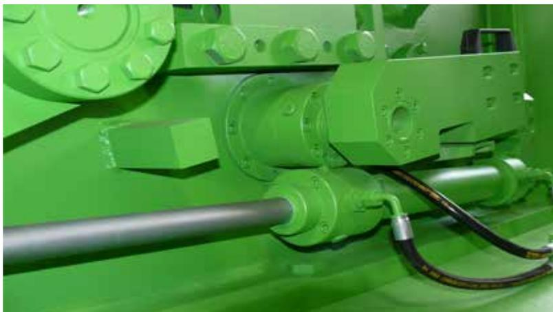
6 | Dieser ungechützte Zylinder von Hänschen ist für zehn Jahre Dreischicht-Betrieb in einer rauen Umgebung zum Beispiel beim Reifenrecycling ausgelegt.
